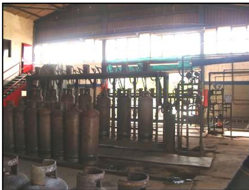
Figura 12.7.- Banco de Prueba Hidrostática
